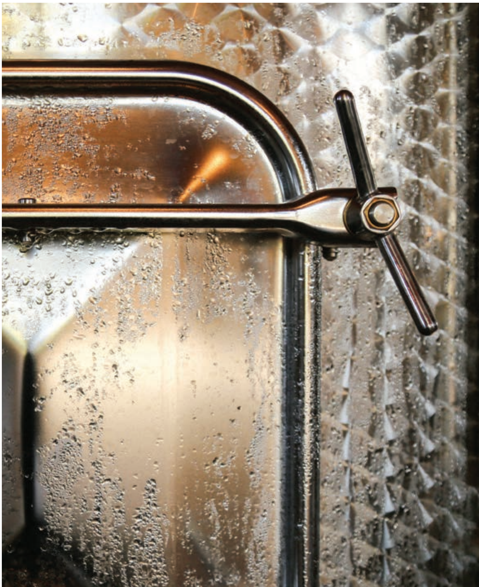
Compuerta del tanque de acero inoxidable transpirado por el proceso a baja temperatura.
