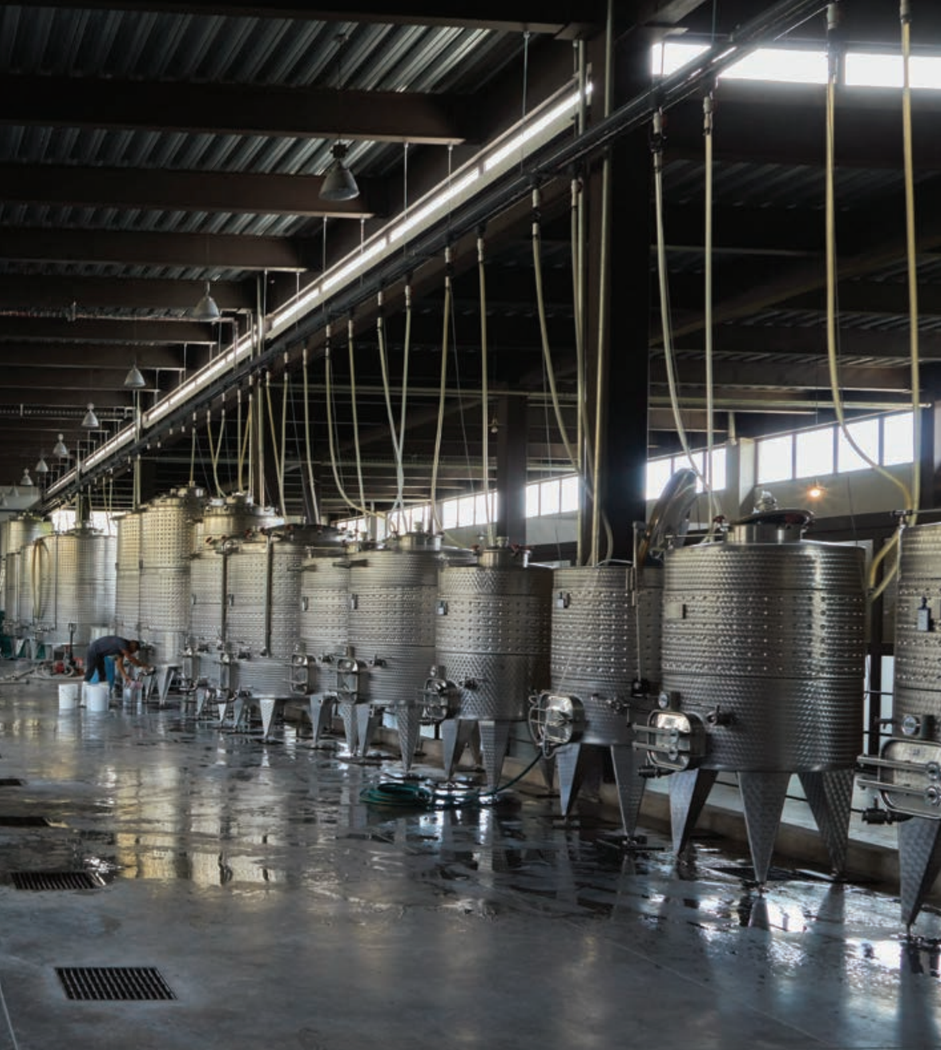
Tanques de acero inoxidable para la fermentación, en la bodega de Viñedo San Miguel.
